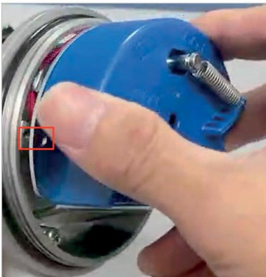
Elektronik und Antriebsmotor können ausgetauscht werden, ohne den Sensor auszubauen
